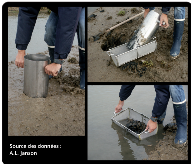
Figure 18. Prélèvement de la macrofaune intertidale de substrat meuble au moyen du carottier à main (diamètre : 20 cm, puis tamisage sur vide de maille de 0,5 mm.)
