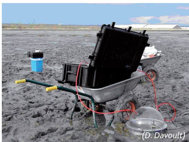
Figure 51. Chambre benthique (mesure de la production nette à la lumière) reliée au système de mesure de la concentration en CO 2 , en place sur le faciès « vaseux » de la vasière Nord.
