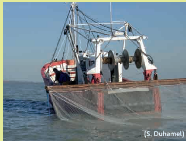
Figure G : Chalutier et guideau. L'engin de pêche est remonté sur le tableau arrière et le filet est entièrement « viré » à bord.
