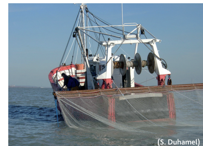
Figure 6. Méthode d'échantillonnage au guideau appliquée dans l'estuaire de la Seine (d'après Morin et al. , 2010)
