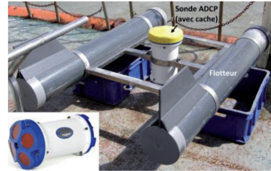
Figure 5 : Sonde ADCP équipée sur un flotteur (équipement du LOG-Wimereux). Ce système a été utilisé dans plusieurs campagnes d'échantillonnage réalisées dans le cadre des projets de recherche coordonnés par Sami Souissi (les campagnes SAZOTOX (2004) ; EURYPOND (2005) et ZOOTRANZ (2008-2010) ont été réalisées dans l'estuaire de la Seine en utilisant les navires océanographiques de l'INSU après évaluation positive de la demande de campagnes océanographiques).
