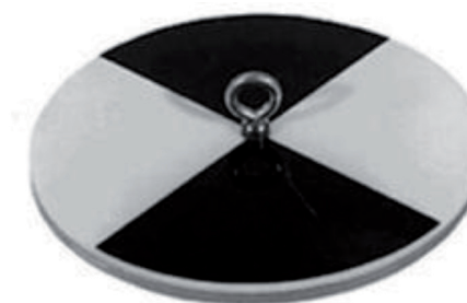
Figure 7 : Disque de Secchi composé de 2 triangles noirs et 2 triangles blancs en vis-à-vis pour créer un contraste plus facile à repérer en immersion
