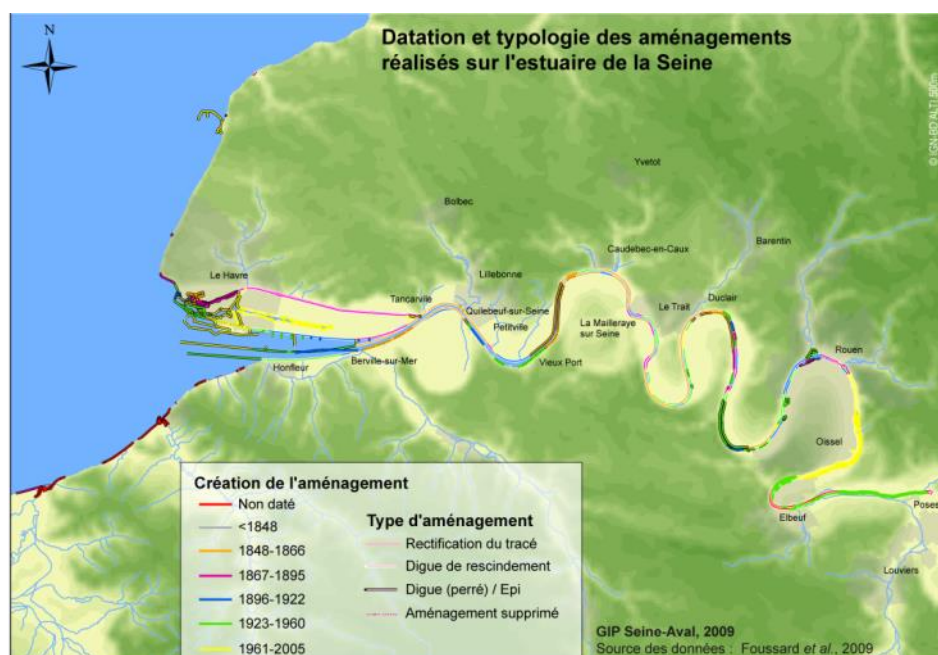
Fig. 7. Aménagements réalisés dans l'estuaire de la Seine
