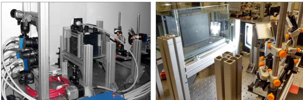
Figure 28. Système expérimental composé de deux systèmes synchronisés de vélocimétrie par suivi de particules en trois dimensions à ETH Zurich. Un système composé de trois caméras équipées de filtres rouges enregistre le déplacement de traceurs fluorescents. Une quatrième caméra, équipée d'un filtre vert et d'un système optique composé de miroirs et permettant une vue stéréoscopique à partir d'une seule caméra, enregistre le déplacement des copépodes. L'aquarium contient un générateur de turbulence et est illuminé par un laser (527 nm). La fréquence d'enregistrement est de 200 images par seconde. Les caméras sont calibrées au moyen d'une plaque sur laquelle des marqueurs sont positionnés à intervalles réguliers, et qui est observée à différentes positions le long de l'axe optique.
