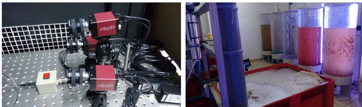
Figure 25. Système de vélocimétrie en trois dimensions par suivi de particules au LOG. Le système est composé de trois caméras qui sont synchronisées, d'un ensemble de disques permettant d'enregistrer pendant plusieurs heures à une fréquence de 60 images par seconde, et d'un éclairage infrarouge puissant. Les copépodes proviennent du projet pilote de culture à grande échelle de copépodes localisé à Boulogne-sur-Mer (location du local via une convention entre la Communauté d'Agglomération du Boulonnais et l'Université de Lille 1) et dirigé par le Prof. Souissi.
