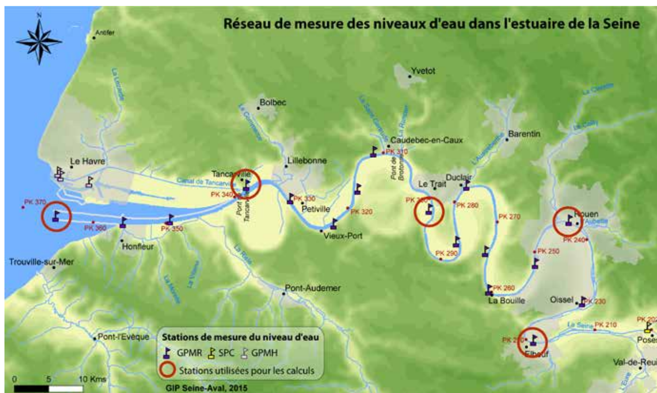
FIGURE 9 Mesure des niveaux d'eau dans l'estuaire de la Seine.
