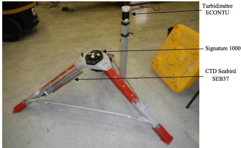
Figure 41 : Equipement déployé à partir du tripode sur la station 1 : ADCP Signature au centre, CTD SBE37 sur un pied du tripode et turbidimètre Wetlabs ECONTU sur perche, cellule de mesure à 1,1 m au-dessus du fond.
