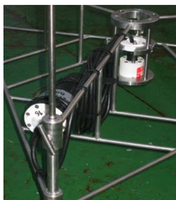
Figure 83. Le système ALTUS : à gauche, le transducteur central relié au module enregistreur/énergie et un pinger ; à droite, détail.
