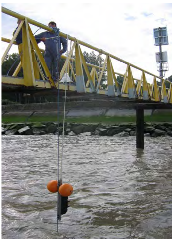
Fig. 25 : Mise à l'eau du turbidimètre de surface, sur système de va-et-vient, à la station Fatouville. Le zoom en haut à droite montre le turbidimètre WetLabs, couplé à une sonde Salinité, Température et Pression. En bas à droite, le système au moment de l'étalement de pleine mer.
