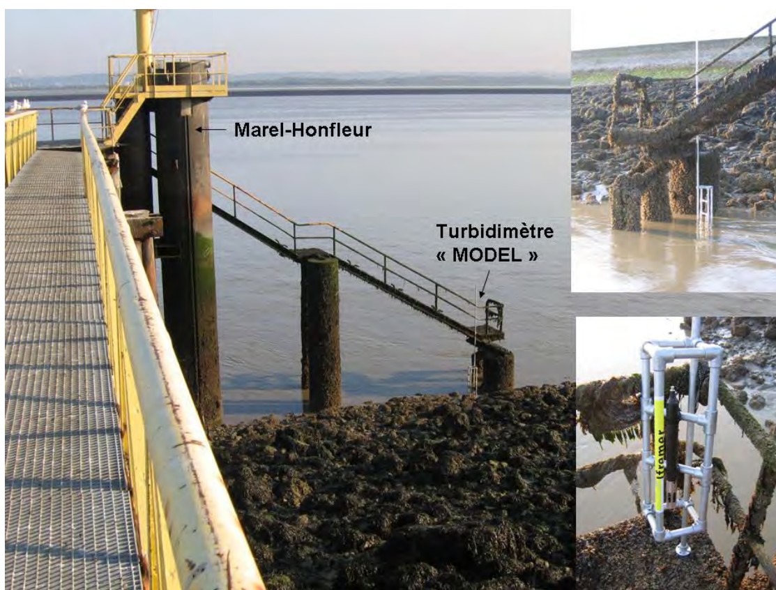
Figure 21a : positionnement du turbidimètre de fond à Honfleur, à proximité du système « Marel »
