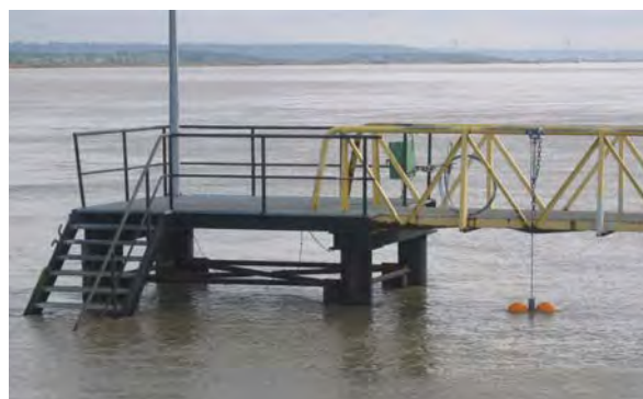
Fig. 25 : Mise à l'eau du turbidimètre de surface, sur système de va-et-vient, à la station Fatouville. Le zoom en haut à droite montre le turbidimètre WetLabs, couplé à une sonde Salinité, Température et Pression. En bas à droite, le système au moment de l'étalement de pleine mer.
