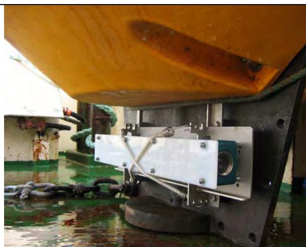
Fig. 24b : Système de montage/démontage de la sonde turbidimétrique sur la queue de la bouée de balisage
