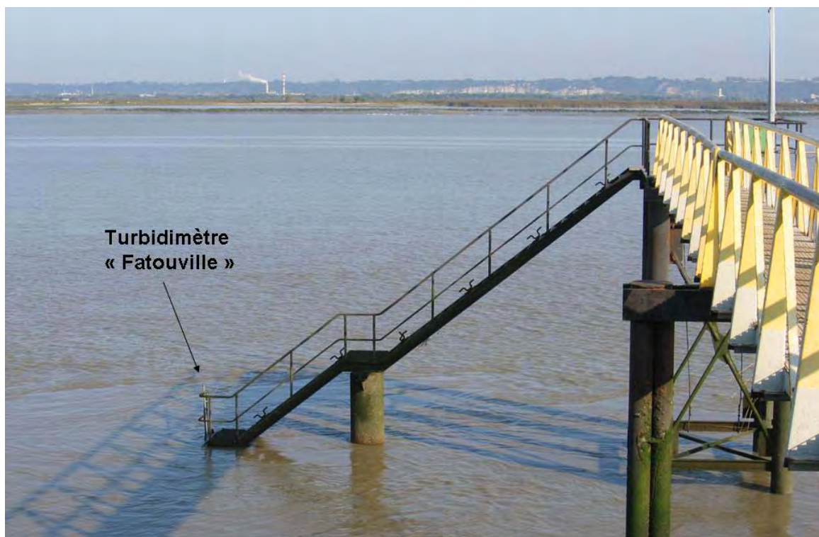
Figure 22 : emplacement de la sonde multiparamètres (turbidité, température, conductivité) à Fatouville.
