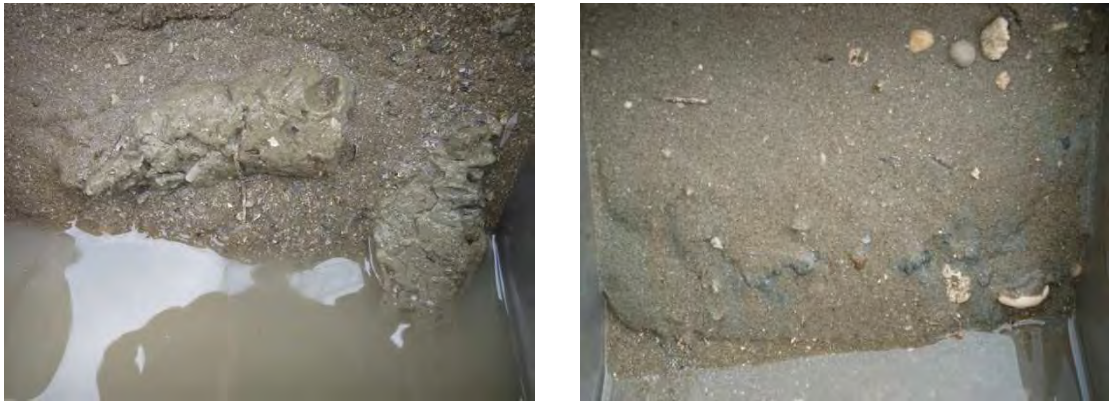
Figure 30. Photographie de deux bennes montrant des galets mous incorporés à la matrice sableuse, en partie pour la photo de gauche (la surface du galet n'est plus lisse) et totalement pour la photo de droite, où il s'agit de "fantôme" de galets mou.
