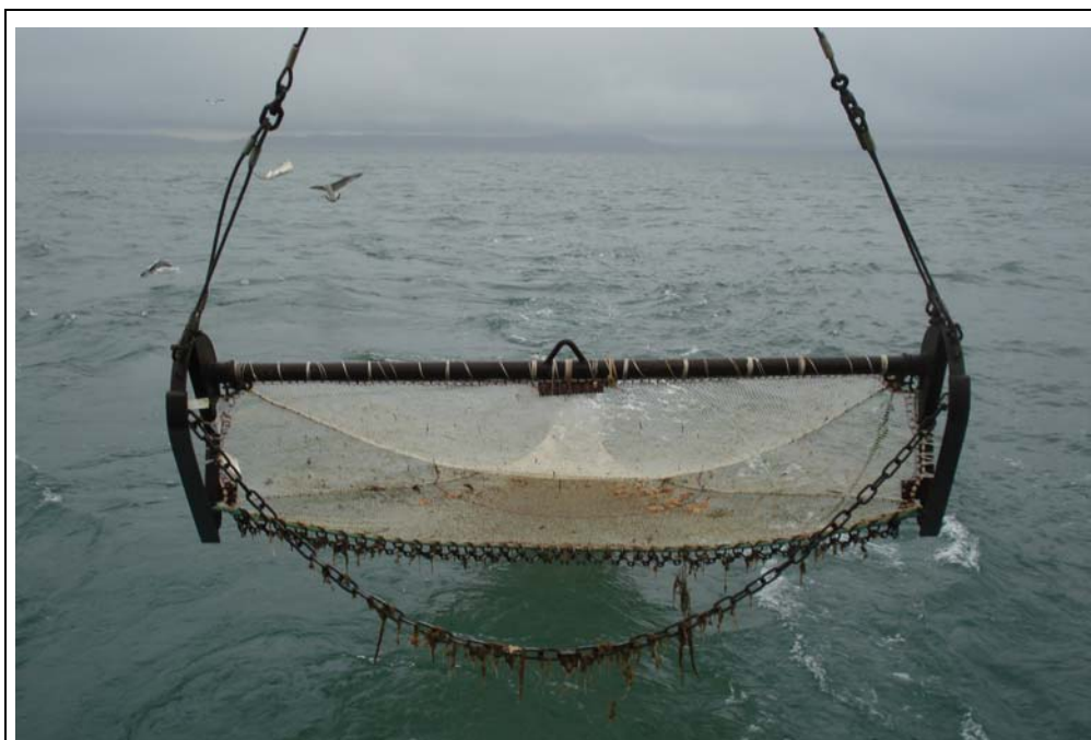
Figure 1 : Chalut à perche utilisé lors des campagnes d'échantillonnage halieutique
