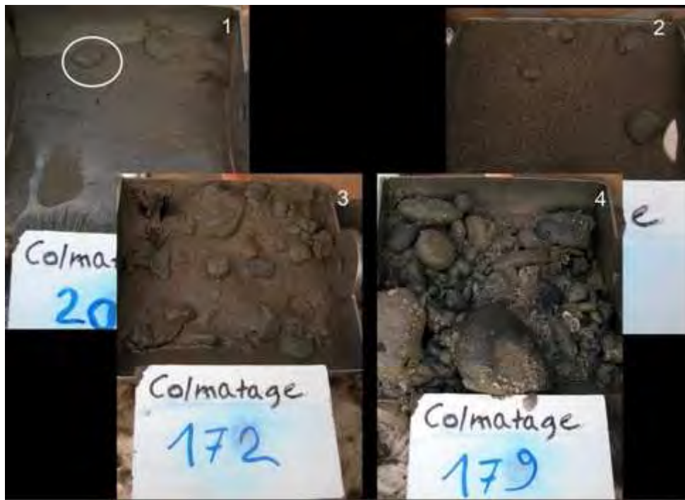
Figure 15. Classification de la présence de galets mous. 0 - pas de galets, 1 - un seul galet, 2 - plusieurs, 3 - la surface sous-jacente est encore visible et 4 - la surface sous-jacente est masquée. A partir de l'indice 4, le faciès descriptif est "sable à galets mous".
