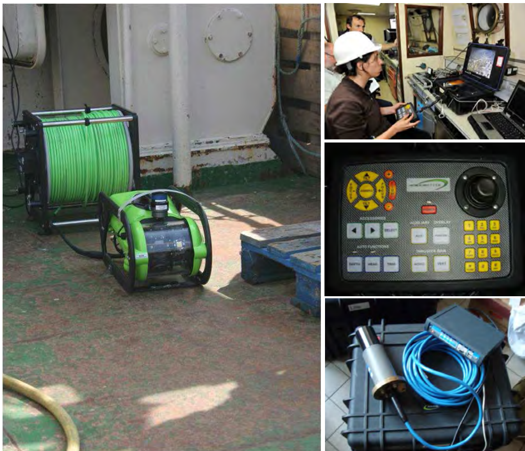
Figure 36. Equipement vidéo avec le ROV (sans les lampes externes) et son ombilic à gauche, et à droite de haut en bas, l'installation dans le laboratoire à bord du « Côtes de la Manche » (crédit photo Olivier Dugornay), le boîtier de commande et le système de positionnement (Trittech Micronav100) (Crédit photos : Sophie Lozach).
