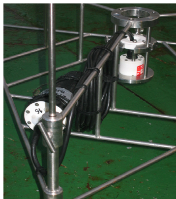
Figure 83. Le système ALTUS : à gauche, le transducteur central relié au module enregistreur/énergie et un pinger ; à droite, détail.
