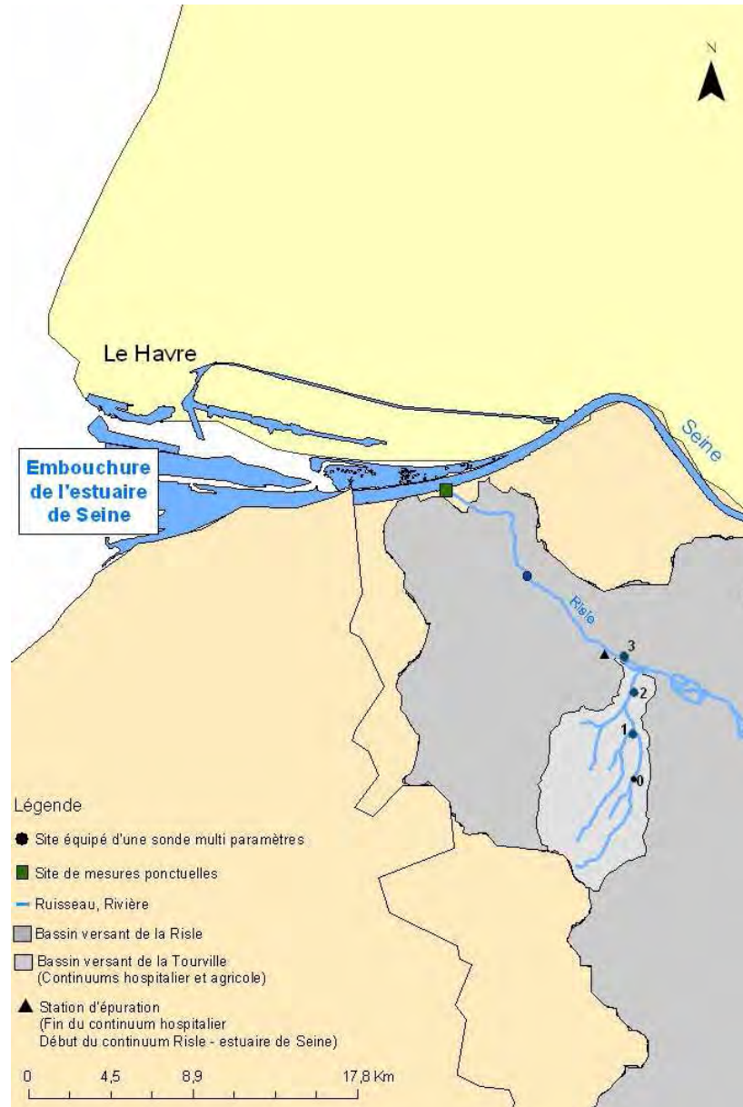
Figure 3 : Cartographie de la zone d'étude du projet FLASH. Des continuums hospitaliers et agricoles jusqu'à la confluence Risle - estuaire de Seine. Le site de mesures ponctuelles situé à la confluence Risle – estuaire de Seine est soumis à une forte dynamique n'ayant pas permis la mise en place de mesures continues. Pour les sites équipés (1, 2, 3) de sondes multi paramètres (Troll In Situ 9500) mesurant la turbidité, conductivité, température, hauteur d'eau, pression toutes les 15 minutes pendant 1 à 2 ans selon les sites. L'échantillonnage des points 1, 2 et 3 du continuum agricole a été réalisé à l'aide de collecteurs ISCO.
