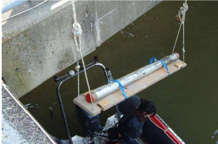
Figure 7. Berceau de manipulation des tronçons pour le transfert entre barge et hangar.
