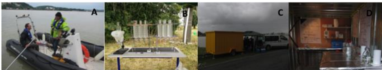
Figure 9: Décantation in situ sur le site de Tancarville. Prélèvement in situ (A), décantations sur la berge (B) et filtrations, analyses granulométriques et stabilisation des prélèvements pour analyses en laboratoire (biologie moléculaire, microbiologie, MEB) sur la berge (laboratoire mobile, C et D).
