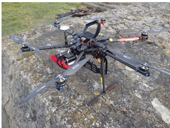
Figure 7 : Mise en œuvre du drone et référencement DGPS des cibles sur vasière.
