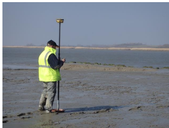
Figure 7 : Mise en œuvre du drone et référencement DGPS des cibles sur vasière.
