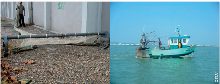
FIGURE 14 Chalut à perche de 3 m utilisé pour les inventaires à l'aval de l'estuaire de la Seine.
