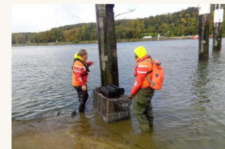
Des scientifiques disposent des cages remplies d'organismes vivants (crevettes, moules, poissons) pour mesurer la qualité de l'eau. © GIP Seine-Aval
