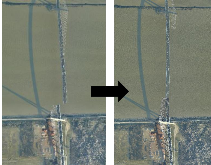
Figure 17 : Exemple de correction au niveau d'un ouvrage d'art
