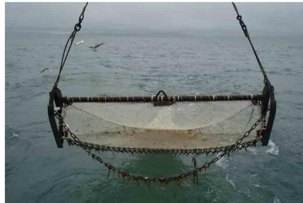
Figure 6 : Chalut à perche utilisé lors des campagnes d'échantillonnage halieutique.
