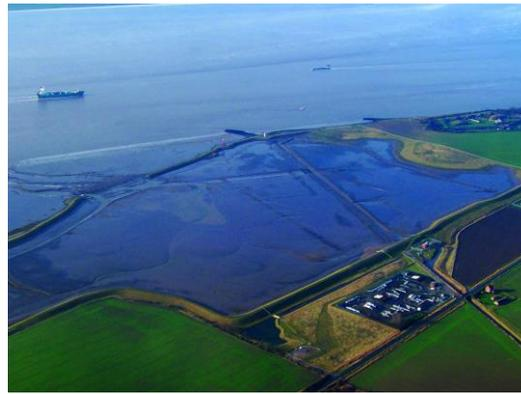
**Figure 6.** Suppression partielle de digue dans le cadre de la gestion du trait de côte (« managed realignment »). Paull Holme Strays, estuaire de l'Humber, Royaume-Uni. (Source : [http://www.tide-project.eu/index.php5?node\\_id=Humber;26&lang\\_id=1](http://www.tide-project.eu/index.php5?node_id=Humber;26&lang_id=1))
