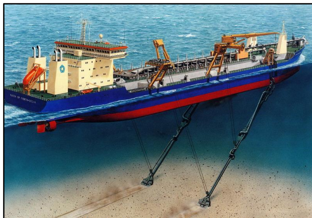
Figure II.35 : Schéma d'une drague aspiratrice en marche à deux élinde (confluence.qpl.nl)
