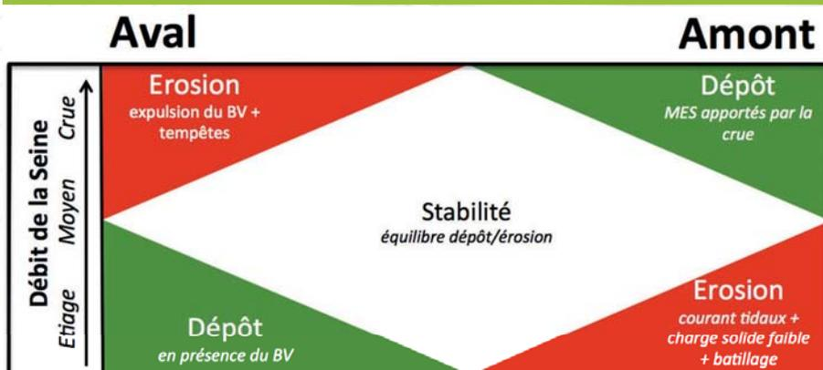
Synthèse qualitative du fonctionnement des vasières intertidales de l'aval vers l'amont en fonction du débit de la Seine et des forçages (marée, houle, batillage).
