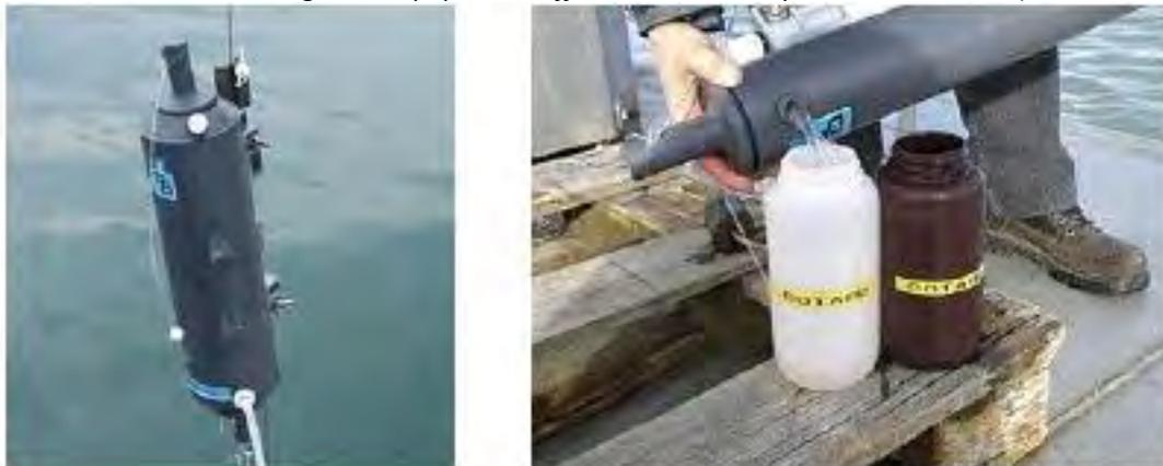
Figure 2 : Prélèvement d'un échantillon de la colonne d'eau à la bouteille Niskin
