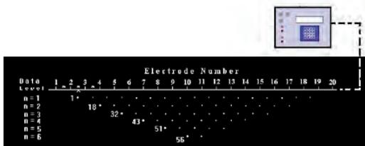
Figure 3.7 : Représentation schématique des données de résistivité apparente en pseudosection pour un panneau de 20 électrodes
