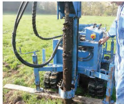
Figure 3.12 : a) photographie de la tarière mécanique auto tractée en cours de déplacement b) photographie de la tarière en cours de forage
