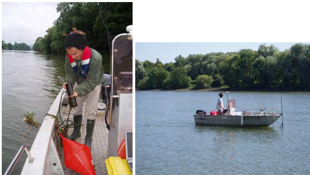
Figure 75 Déchargement des informations enregistrées sur un hydrophone fixe par connection Blue tooth (g) et tracking mobile (d)
