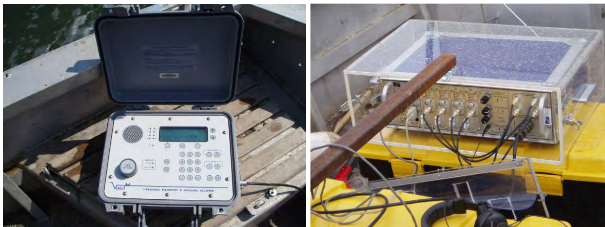
Figure 70 Récepteurs utilisés pour le tracking manuel : Vemco VR100 (g) et Vemco VR28 (d)
