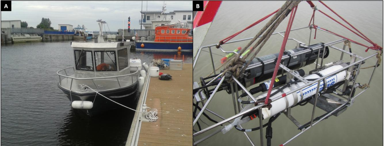
**Figure 2** : (A) Illustration du dispositif de mesure – (B) Photo de la cage équipée des instruments, YSI/CTD (OBS-3+) et LISST.
