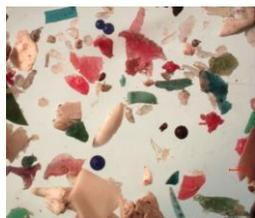
Mélange de plastiques de Seine cryobroyés et tamisée à 50 µm : PE (65%) + PP (25%) + PS (10%)
