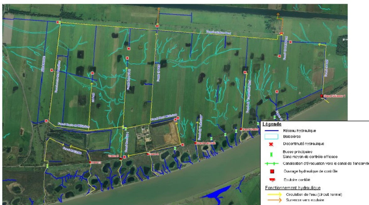
Figure 27. Fonctionnalités hydrauliques du marais de Hode (source RNNES depuis CSLN, 2012)
