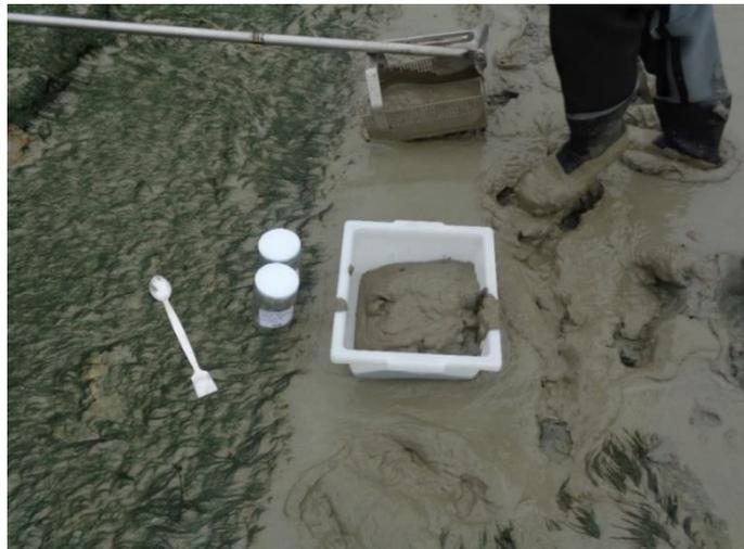
Figure 7 : Prélèvement de sédiment de surface sur une banquette latérale de la Seine.
