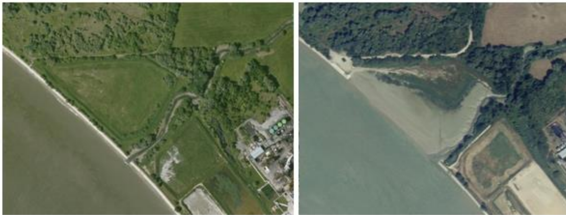
Figure 31. Exemple de restauration du gradient latérale par suppression de digue dans l'estuaire de la Seine à Lillebonne
