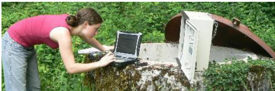
Mesure de niveau d'eau et de la qualité des eaux (BRGM)
