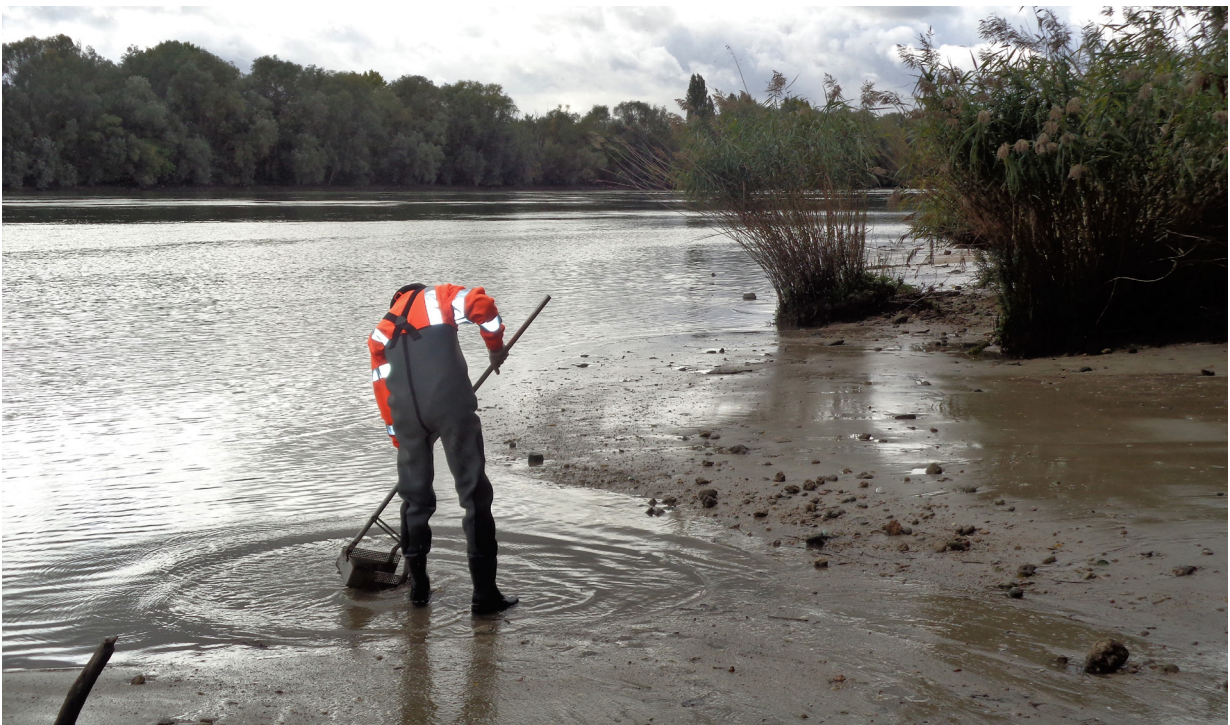
→ Prélèvement de sédiments superficiels sur une banquette latérale de l'estuaire.
