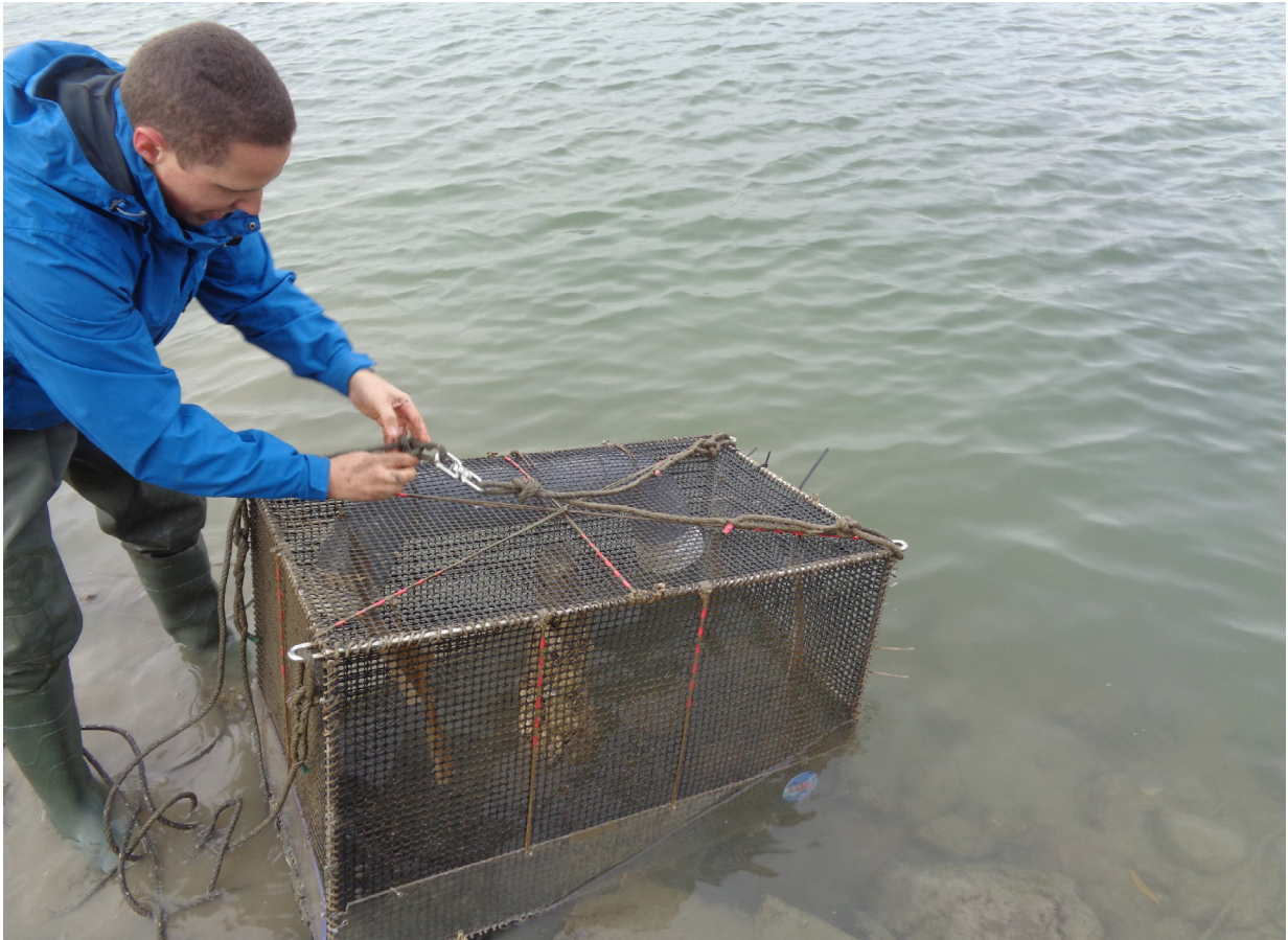
→ Système d'encagement pour suivre l'impact de la contamination sur les poissons.
