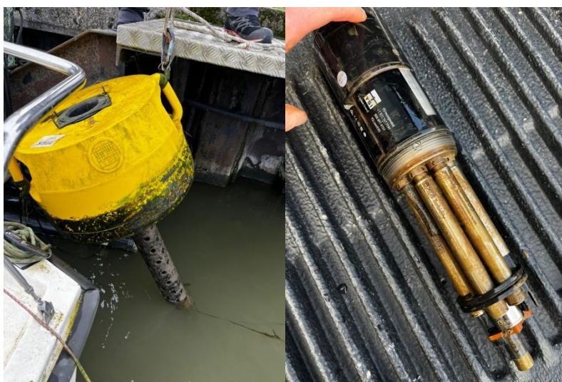
Figure 2 : Photographies de la bouée DB600 et de la sonde YSI EXO2S – à noter l'important biofouling sur la bouée, sur la crépine et sur les capteurs observés en janvier 2026.
